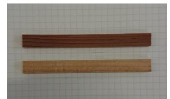
図3. 試験体木材 スギ(上)、ブナ(下)
