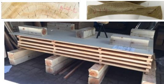
100℃試験によるコウヨウザンの変形の様子(上)と天然乾燥試験の様子(下)
