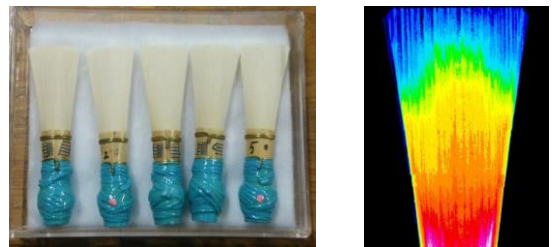
吹き心地が異なるバスーンリードの写真(左)とX線CTで求めたブレード部の厚さ分布画像(右)
