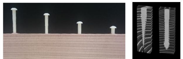
樹脂製ねじの写真(左)と木材中での様子(右)
